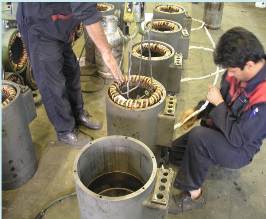
استقرار هسته در درون پوسته ماشین الکتریکی AC
