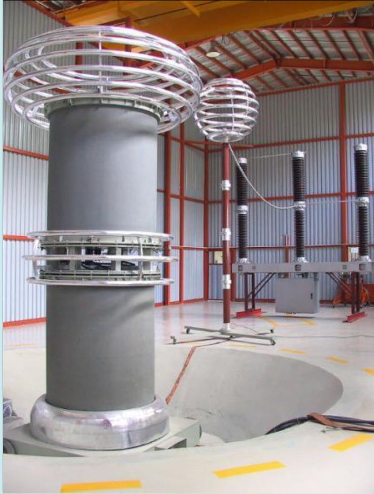
سیستم AC تست پاور فرکانسی 600 kV
