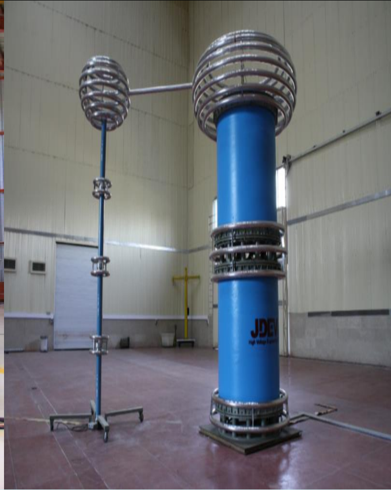
سیستم AC تست پاور فرکانسی 800 kV
