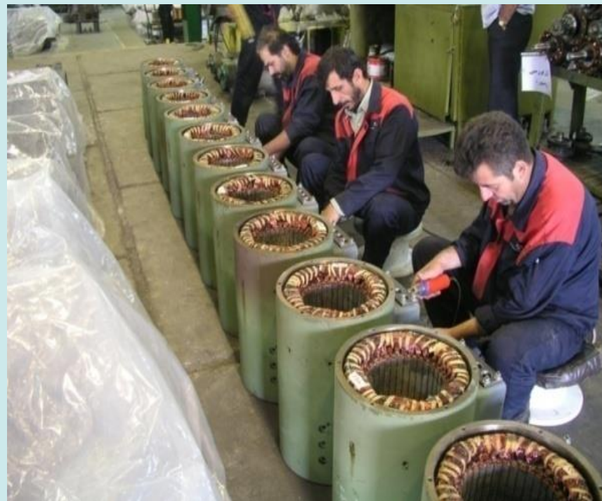
سیم پیچی استاتور ماشین الکتریکی AC
